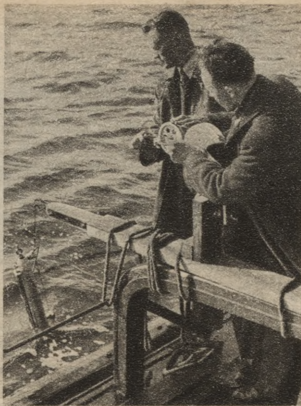
Batometrs — aparāts jūras ūdens paraugu ņemšanai — sagatavots nolaišanai dzelmē.
